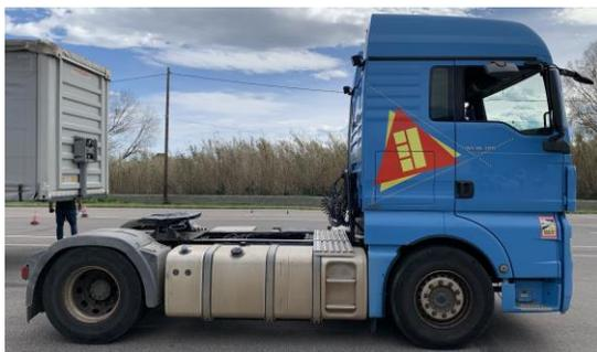
**3/ Annoncer :** les rétroviseurs, les vitres, la cabine et les roues ne présentent aucune anomalie.
