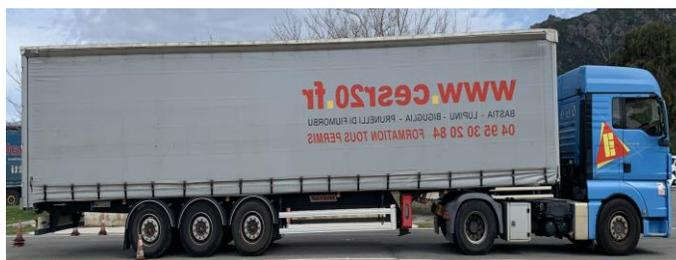
**2/ Annoncer :** Je conduis un MAN de 480 CV. Le porte à faux avant est 1m50 et 4m50 à l'arrière. Les plaques de tare sont propres et lisibles. La barre de protection est en bon état, les dispositifs réfléchissants sont bons sur toute la longueur.
