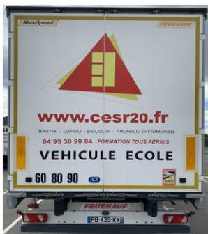
**3/Annoncer :** les disques de limitation de vitesses sont propres et lisibles et bien collés, les dispositifs réfléchissants sont en bon état, la plaque d'immatriculation est propre, lisible et bien fixée, la barre anti encastrement est en bon état, bien fixée.
