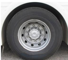
Le garde boue est en bon état, aucune fuite d'air à la suspension, la bande de roulement est en bon état, il n'y a pas de déchirure ni de hernie sur le flanc, pas de corps étrangers dans le jumelage, les écrous sont tous présents et visuellement bien serrés, la pression d'air est bonne.
