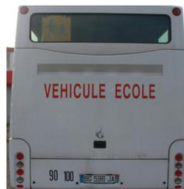
**4/ Annoncer :** les feux de gabarit (4), la vitre, la caisse, les feux de détresse et de position ne présentent aucune anomalie. Aucune tâche sous le véhicule. Demander l'aide de l'inspecteur pour contrôler les feux stop.
