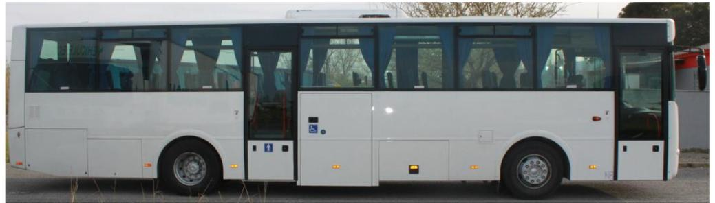
**2/ Annoncer :** La plaque de tare est propre et lisible. Je conduis un car MAN scolaire 3 de 280 cv et 55 places assises. Le porte-à-faux avant est de 2,50 m et à l'arrière de 3 m.
